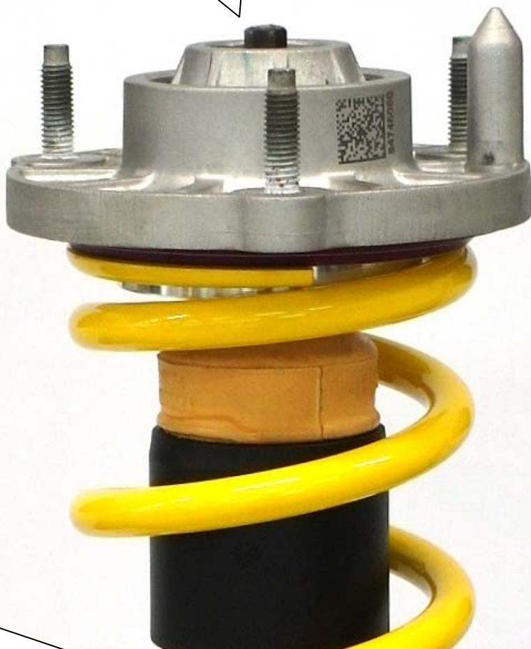
Bei Dämpferausführungen mit Druckausgleichsbehälter ist dieser zur Fahrzeugaußenseite zu montieren.
