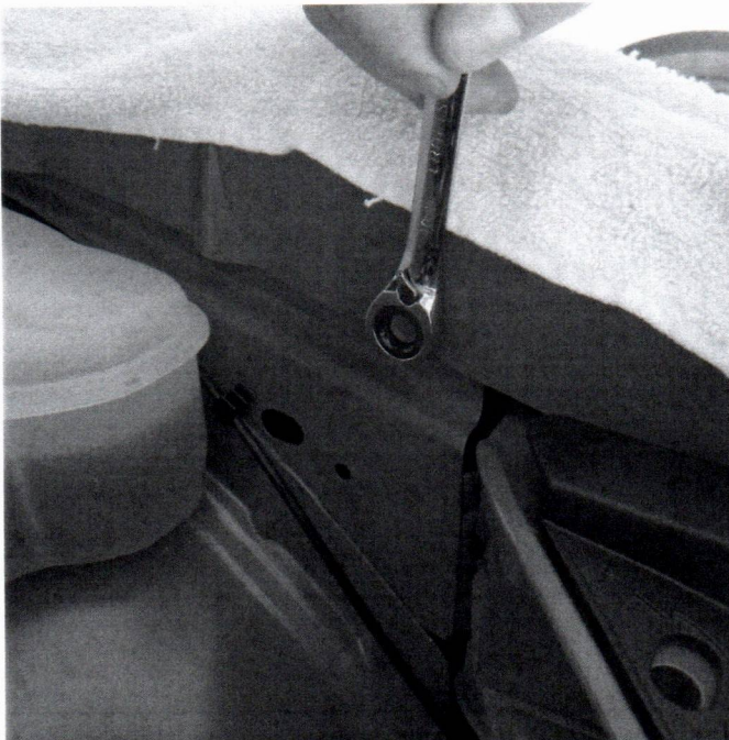
15. Remove the inner fender bolt.
