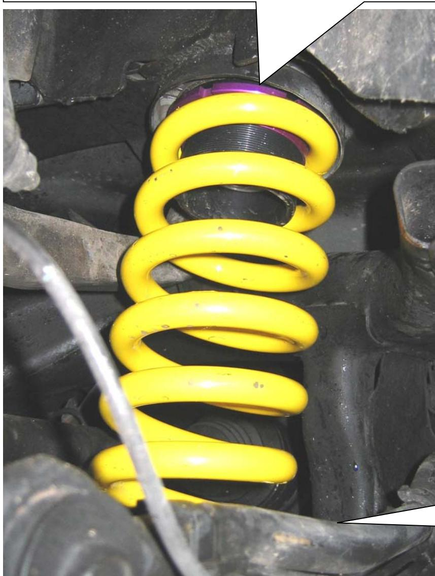
Am unteren Ende der Feder wird die originale Federunterlage weiterverwendet.
