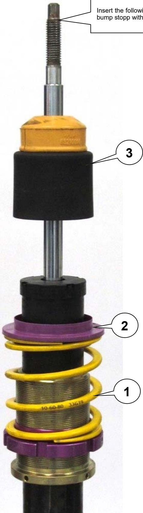
Folgende mitgelieferte Teile in der Reihenfolge auf das Federbein aufstecken: Vorspannfeder 1, Zwischenring 2 und Anschlagelement mit Staubschutz 3.
