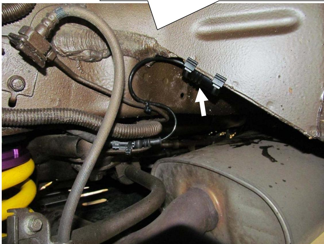
Leitung und Steckverbindung mit Kabelbindern befestigen.
