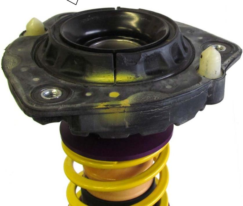
Nach erfolgtem Einbau des Fahrwerkes ist die Freigängigkeit der Reifung zum VA-Federbein zu überprüfen. Das Mindestabstandsmaß darf an der engsten Stelle **5 mm** nicht unterschreiten und ist gegebenenfalls mittels geprüfter Distanzscheiben wieder herzustellen.
