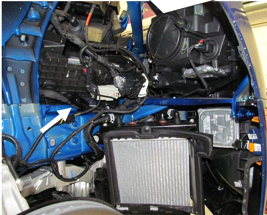
Leitung und Steckverbindung mit Kabelbindern befestigen.
