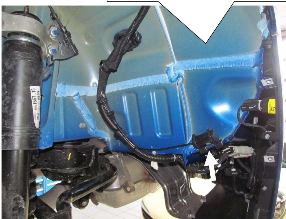
Leitung und Steckverbindung mit Kabelbindern befestigen.
