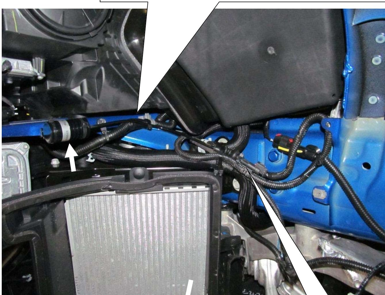
Leitung und Steckverbindung mit Kabelbindern befestigen.
