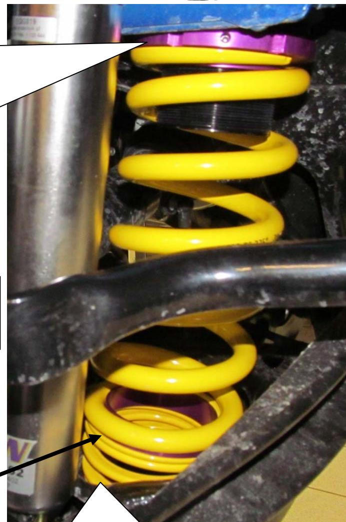
Am unteren Ende der Feder wird der mitgelieferte Adapterring verwendet. Die serienmäßige Federunterlage entfällt.
