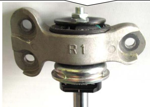
Die HA-Verstellung wird oben zwischen Feder und Karosserie montiert. Die serienmäßige Federunterlage entfällt. Zum Korrigieren (verdrehen des Gewindefingers) der Fahrzeughöhe, ist die HA-Verstellung aus dem Fahrzeug zu demontieren.
