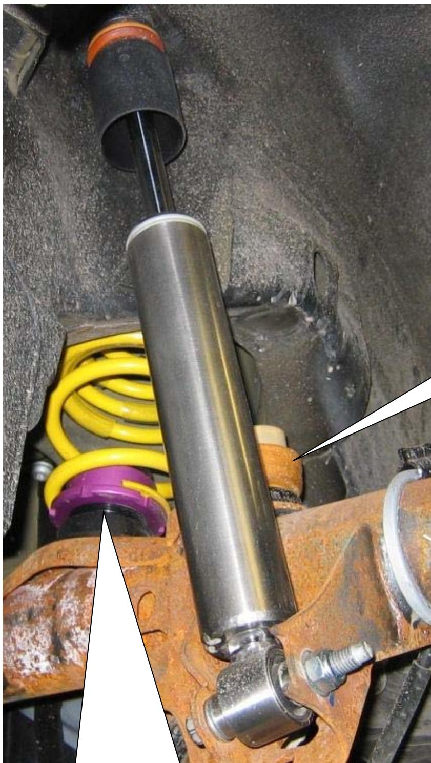
Die HA-Verstellung wird oben zwischen Feder und Karosserie montiert. Die serienmäßige Federunterlage entfällt. Zum Korrigieren (verdrehen des Gewinderings) der Fahrzeughöhe ist die HA-Verstellung aus dem Fahrzeug zu demontieren.
