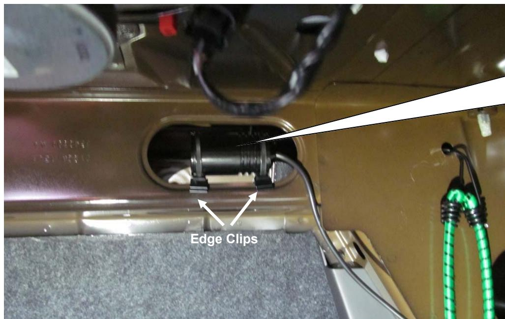
HA Elektronik Satz mit den mitgelieferten Edge Clips in der Karosserieöffnung mit befestigen.
