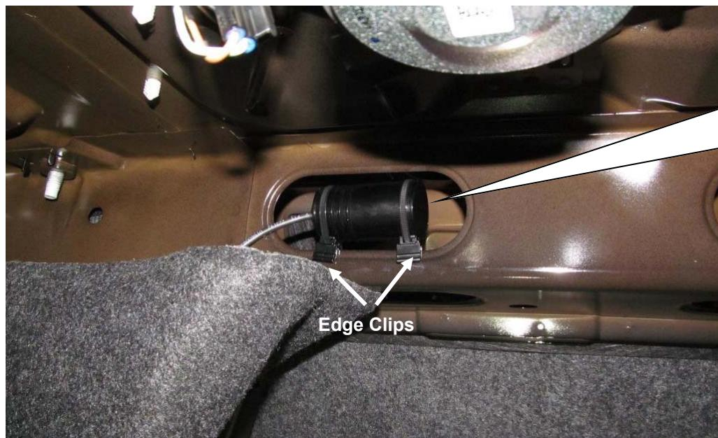
HA Elektronik Satz mit den mitgelieferten Edge Clips in der Karosserieöffnung mit Edge Clips befestigen.
