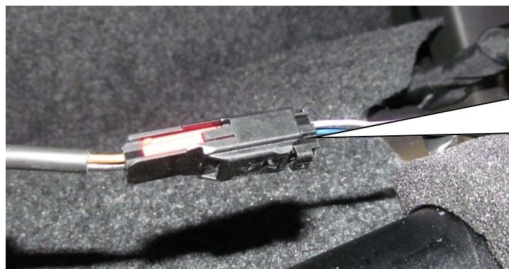
Stecker des Elektronikbauteils in die Buchse einstecken. Auf die korrekte Verriegelung des Steckers achten! Anschließend die neue Leitung mit Kabelbindern befestigen.
