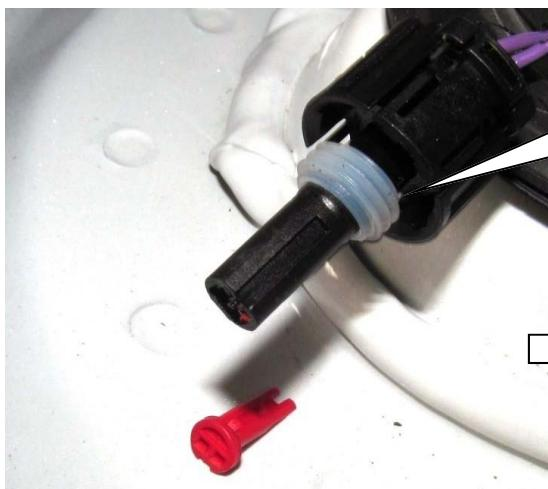
2. Rote Steckersicherung aus dem Stecker herausziehen. Originale Dämpferleitungen mit geeignetem Werkzeug aus der Stecker auspinnen.
